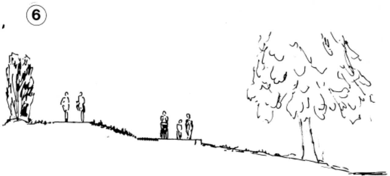
Abbildung 14. Durch Geländeabtrag wird die Aare aufgeweitet (analog Schwanenwiese). Silberweiden als typische Uferbäume werden angepflanzt. Die Flusslandschaft wird für die Stadtbewohnerinnen besser erlebbar. Blick flussaufwärts.
